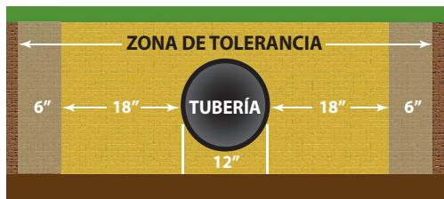
En la zona de tolerancia debe utilizarse el cavado manual o la excavación suave, que incluye la hidroexcavación (excavación con agua a alta presión y vacío). En todo momento durante el proceso, los excavadores deben monitorear atentamente las condiciones como la presión y temperatura del agua para prevenir daños a la tubería u otras instalaciones subterráneas.
